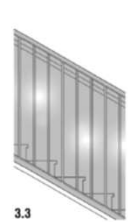
Fig. 3 Nel caso di intervento sul costruito e in presenza di parapetti non rispondenti alla norma (3.1), qualora non fosse possibile o opportuno procedere con la loro sostituzione, si può intervenire attraverso l'infittimento della trama dei montanti e/o traversi (3.2) che definiscono la geometria del parapetto fino a garantire l'inattraversabilità, oppure attraverso l'apposizione di schermi interni o esterni, trasparenti o grigliati. (3.3)
